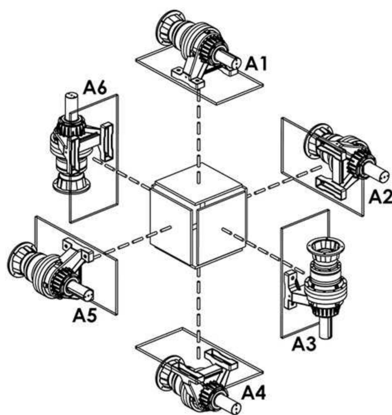
موقعیت های تنظیم شده در شکل از A1 تا A6 به عنوان مرجع، جهت قرارگیری گیربکس های پایه دار را مشخص می کند.
